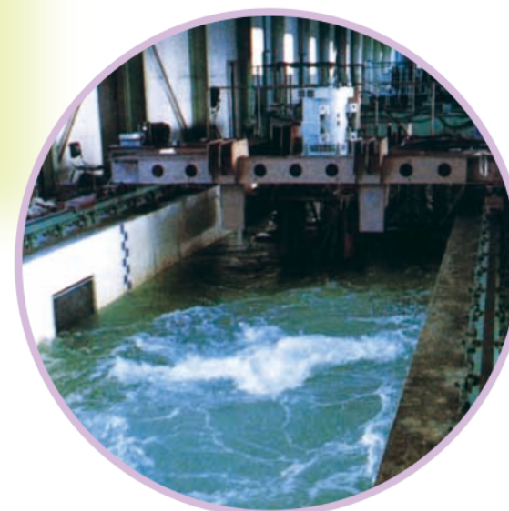
回流水槽での実機試験 (Tank Test)
